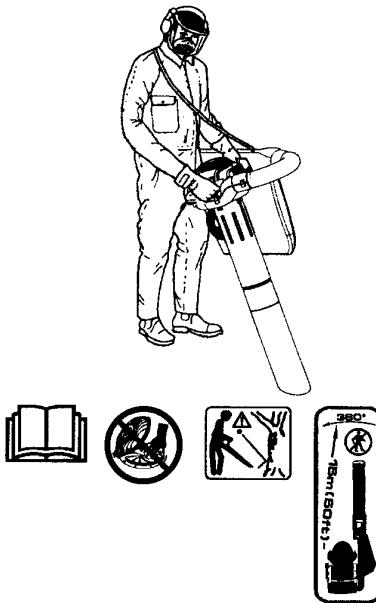
**Avertissement!** Toujours vérifier avant le démarrage que le sac collecteur est intact et que sa fermeture à glissière fermée. Ne jamais utiliser de sac déchiré, en raison des risques de blessures d'objets volants. Faites attention, particulièrement si vous travaillez de la main gauche. Evitez tout contact direct du corps avec la zone d'échappement.
