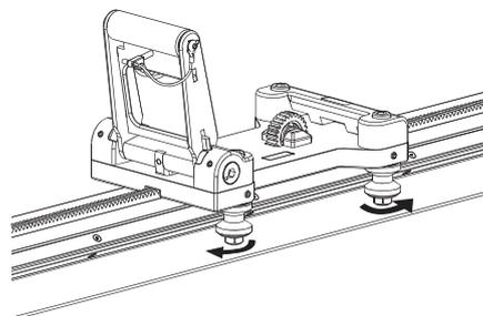
Удерживайте гаечный ключ на 16 мм в необходимом положении и затяните два стопорных винта с помощью шестигранного ключа на 3 мм.
