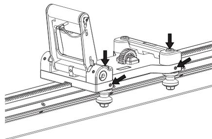
Осторожно поверните валы с помощью гаечного ключа на 16 мм таким образом, чтобы направляющие колеса опирались на направляющую.
