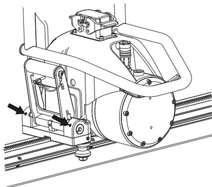
Поворачивайте две эксцентриковые втулки шестигранным ключом на 8 мм, пока вал не будет затянут и расположен параллельно резчику.
