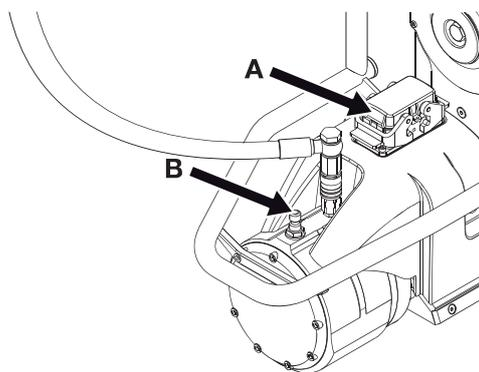
Как только кабель питания будет подсоединен к резчику, карабин кабеля необходимо прикрепить к резчику для предотвращения давления на штепсель во время работы. Карабин необходимо зафиксировать на одном из отверстий кронштейна на рукоятке, которая закреплена винтами на задней части приводного двигателя.
