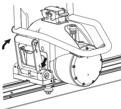
Затем закрепите зафиксированную рукоятку с помощью стопорного штифта.
