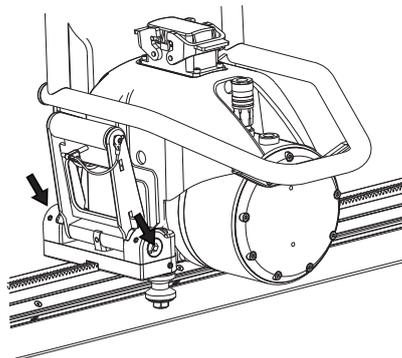
Затяните два стопорных винта с помощью шестигранного ключа на 3 мм.
