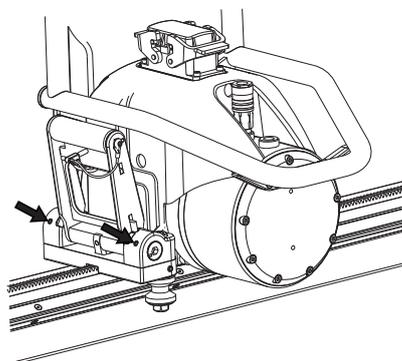
Убедитесь, что фиксирующая рукоятка отрегулирована должным образом, открыв и закрыв ее и проверив, чтобы подпружиненный фиксатор находился в заблокированном положении.
