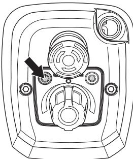
Обратите внимание! Это относится к бурильным машинам, оснащенным прерывателем цепи при замыкании на землю. Если сработал прерыватель цепи при замыкании на землю, то на этом этапе его можно переустановить.
